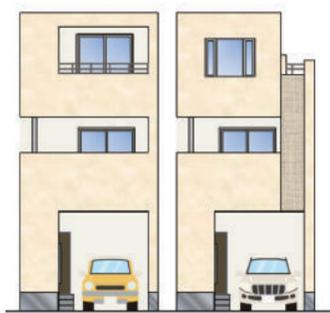
5は本件建物の外観イメージ図です。このようなスリムな3階建てが2棟近接して建っていました。住宅の間口は狭く3.6mです。この2棟は6に示すようにお互いが挨拶するように中央部に向かって約20mm不同沈下しました。住宅の間口が狭いので20mmでも傾斜角は大きく5/1000を超えていました。
