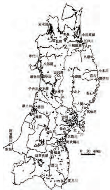
東北地方の平野部の約30%は腐植土地盤 (及川 洋:「基礎工」2003.3より)
