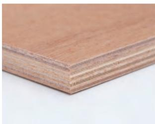
薄いベニヤ板を貼り合わせて作る合板。縦方向と横方向の繊維を直交させて強度を高める。
