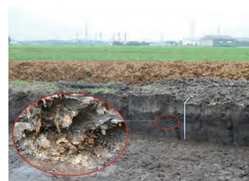
の中川低地の中の水田です。稲作が行われていない場所には夏場は葦(ヨシ、アシ)などの水生植物が繁茂します。これが毎年冬場は枯れてそのまま水中で堆積して残ります。この水田部分を掘ってみると6の様に地表直下から1m付近にかけて腐植土層が堆積しています。腐植土を取り出して含水比を計ってみると表層から0.5m付近の含水比は28.1%、0.8m付近は49.3%でした。その下層の沖積シルト層の含水比が82%でしたからかなり高い含水比でした。
