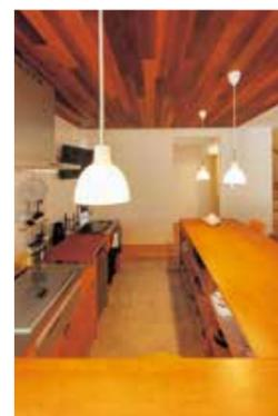
キッチンの床を150mm下げ、調理する人と座る人の視線が合いやすい高さに。造作キッチンへの取り組みは初めての経験だった。コの字形のテーブルには大勢が集える。
